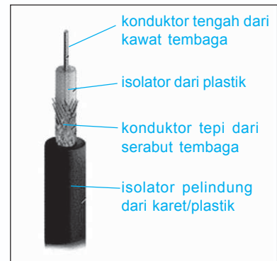
Gambar 5.25 Tembaga bersifat konduktor dan plastik/karet bersifat isolator disusun untuk membuat kabel koaksial.
