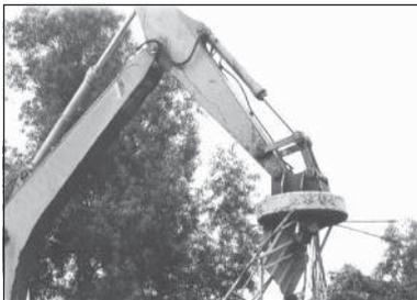
**Gambar 7.20** Alat pengangkat rongsokan logam.
