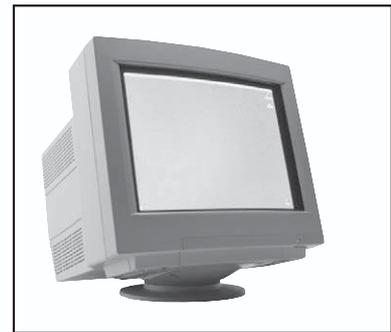
**Gambar 8.13** Monitor komputer menggunakan transformator step up untuk menaikkan tegangan guna mengaktifkan tabung sinar katoda (CRT).
